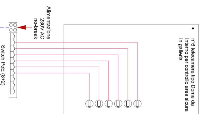
Allo Switch Giga Ethernet della centrale TVCC ubicata nel locale Gestione Emergenze del fabbricato TECNOLOGIE della piazzale di sicurezza della finestra (galleria di Hirpinia)
