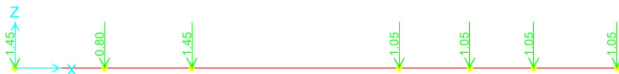
Fig. Carichi agenti sulla struttura ( in kN). In ordine da sinistra a destra: piede sx della centralina oleodinamica (1.45 kN) , segnale indicatore (0.8 kN), piede dx della centralina oleodinamica (1.45 kN); piedi dei due trasformatori RD.
