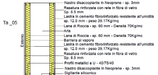
PARETE DIVISORIA TIPO Ta_05 CON POTERE FONOISOLANTE Sp. 554 mm (A.P. 154)
