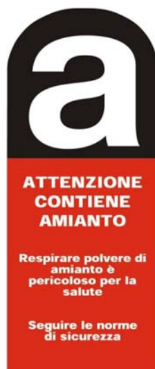
Figura 3 – Pittogramma per individuazione materiali contenenti Amianto
