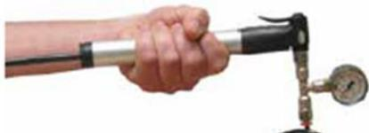
Il test di riferimento delle giunzioni a bicchiere o manicotto delle tubazioni TECH3 in cantiere con sistema TWICE prevede la verifica della tenuta del giunto alla pressione di 0,5 bar.
