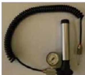
Il sistema TWICE per la verifica di tenuta della giunzione, prevede l'utilizzo di un dispositivo di insufflaggio manuale dell'aria, dotato di un manometro di controllo della pressione e di un terminale idoneo all'introduzione dentro alla guarnizione dell'apparato predisposto sul bicchiere o manicotto.
