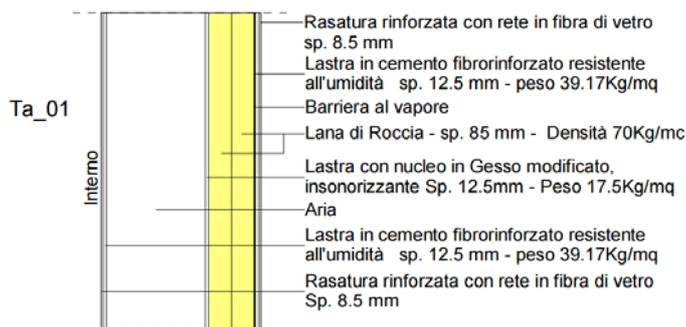
Ta\_01a - Parete con pannelli a secco, sottostruttura metallica - sp. 600 mm (A.P. 119)
