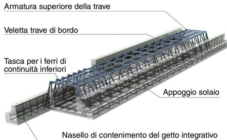
L'unione con i solai e i pilastri avviene attraverso la messa in opera di armature integrative e dei getti di completamento eseguiti con calcestruzzo di classe minima C25/30 ( $R_{ck} \geq 300$  kg/cm<sup>2</sup>), della parte tralicciata e dei nodi travi-pilastro.
