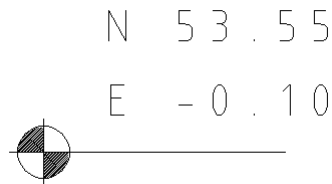
Fig. 30 - Il tipo di famiglia di sistema “Coordinate punto” con nidificata la famiglia caricabile “MUS-Quote_Altimetriche_Punto_Pianta” per la quotatura dei punti nelle viste in pianta
