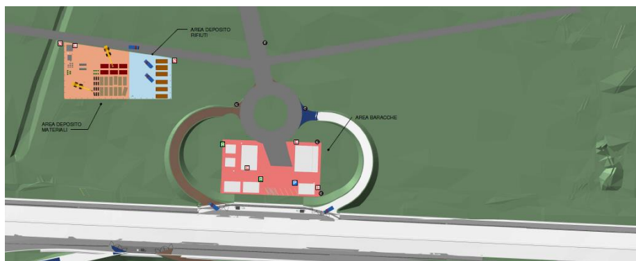
Figura 6 – Vista del varco temporaneo e delle rampe di accesso all'area di lavoro
