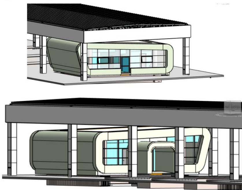
Figura 31: Edificio Casse e Carburanti sotto la struttura della pensilina in acciaio
