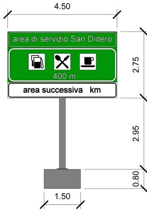
*Figura 4 – Geometria Monopali Tipo "D"*
