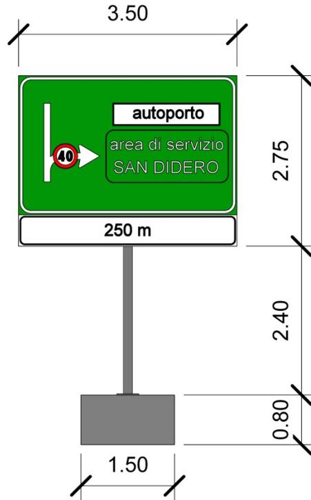
*Figura 3 – Geometria Monopali Tipo "C"*
