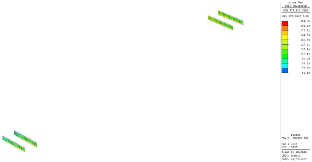
Figura 20 – Inviluppo SLU tensioni ideali \sigma_{id} sulle anime dei conci 2 / 20
