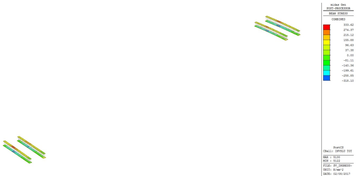
Figura 33 – Involuppo SLU tensioni ideali \sigma_{id} sulle piattabande dei conci 3 / 19 (sp. piatti t \leq 40 mm)
