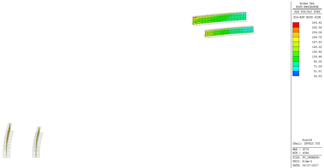
Figura 26 – Inviluppo SLU tensioni ideali \sigma_{id} sulle anime dei conci 8 / 14
