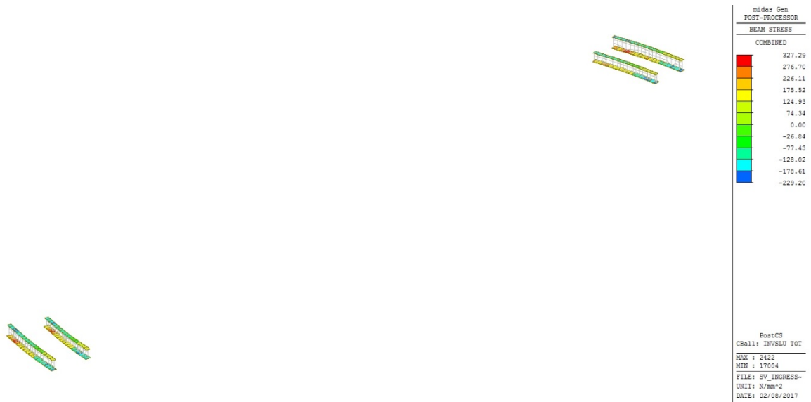
Figura 34 – Involuppo SLU tensioni ideali oid sulle piattabande dei conci 4 / 18 (sp. piatti t \leq 40 mm)
