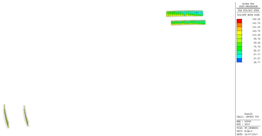
Figura 25 – Inviluppo SLU tensioni ideali \sigma_{id} sulle anime dei conci 7 / 15
