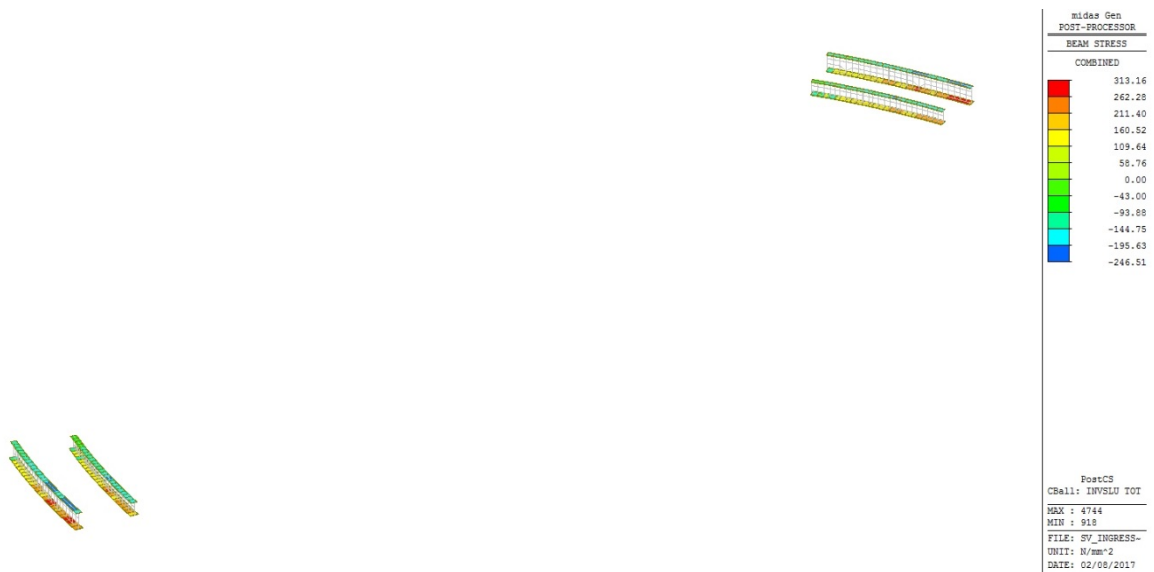
Figura 35 – Involuppo SLU tensioni ideali oid sulle piattabande dei conci 5 / 17 (sp. piatti t \leq 40 mm)
