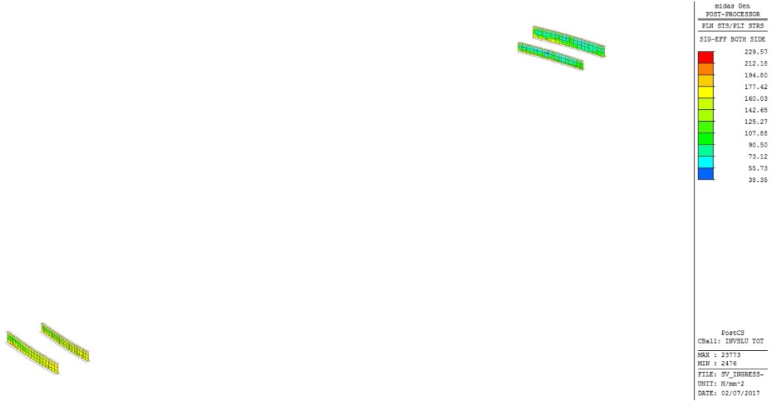
Figura 22 – Inviluppo SLU tensioni ideali \sigma_{id} sulle anime dei conci 4 / 18
