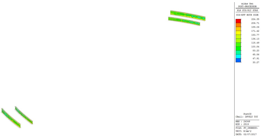
Figura 23 – Inviluppo SLU tensioni ideali \sigma_{id} sulle anime dei conci 5 / 17
