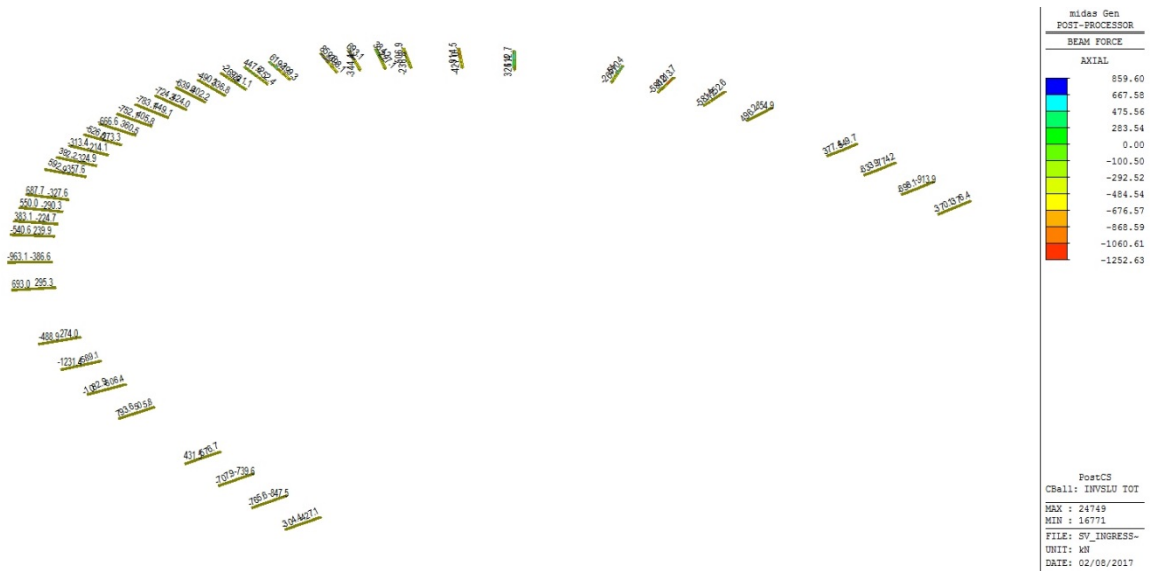
Figura 44 – Sforzi normali nei correnti inferiori - Involuppo SLU
