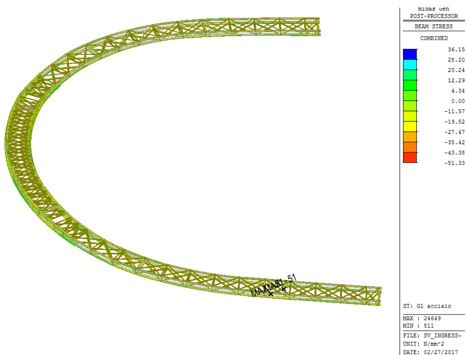
Figura 69 – Tensioni sulle aste in fase di montaggio
