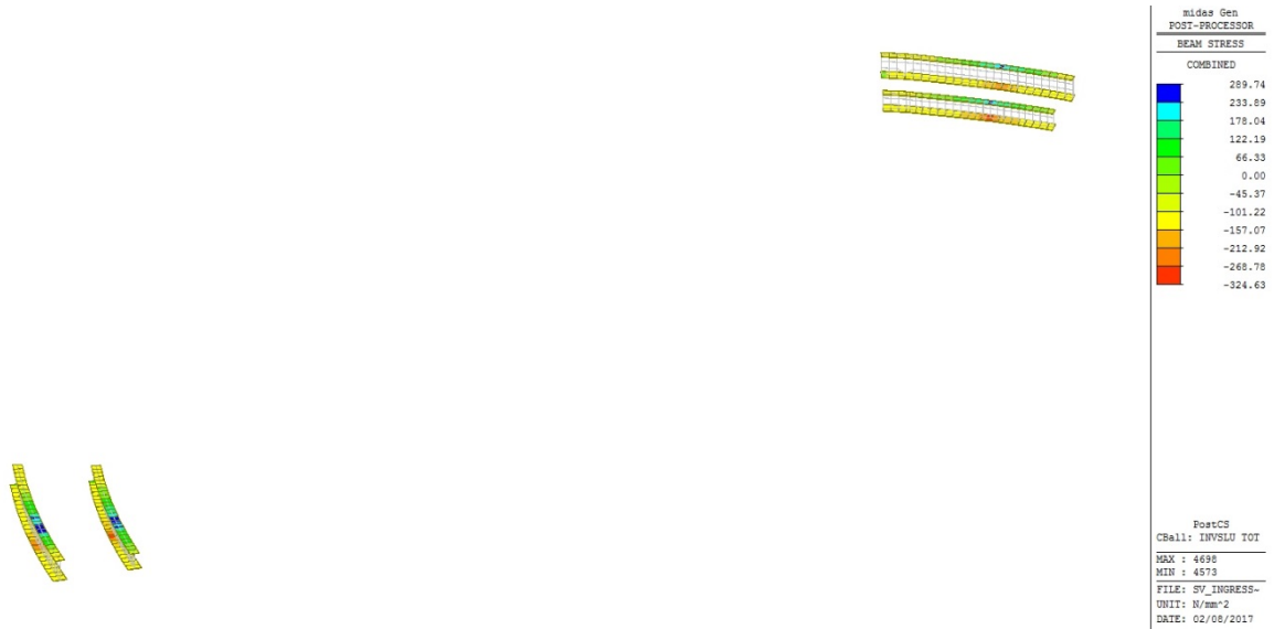
Figura 36 – Involuppo SLU tensioni ideali oid sulle piattabande dei conci 6 / 16 (sp. piatti t \leq 40 mm)
