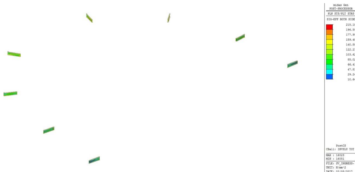
Figura 48 – Tensioni ideali \sigma_{id} sulle anime dei traversi di testata - Involuppo SLU
