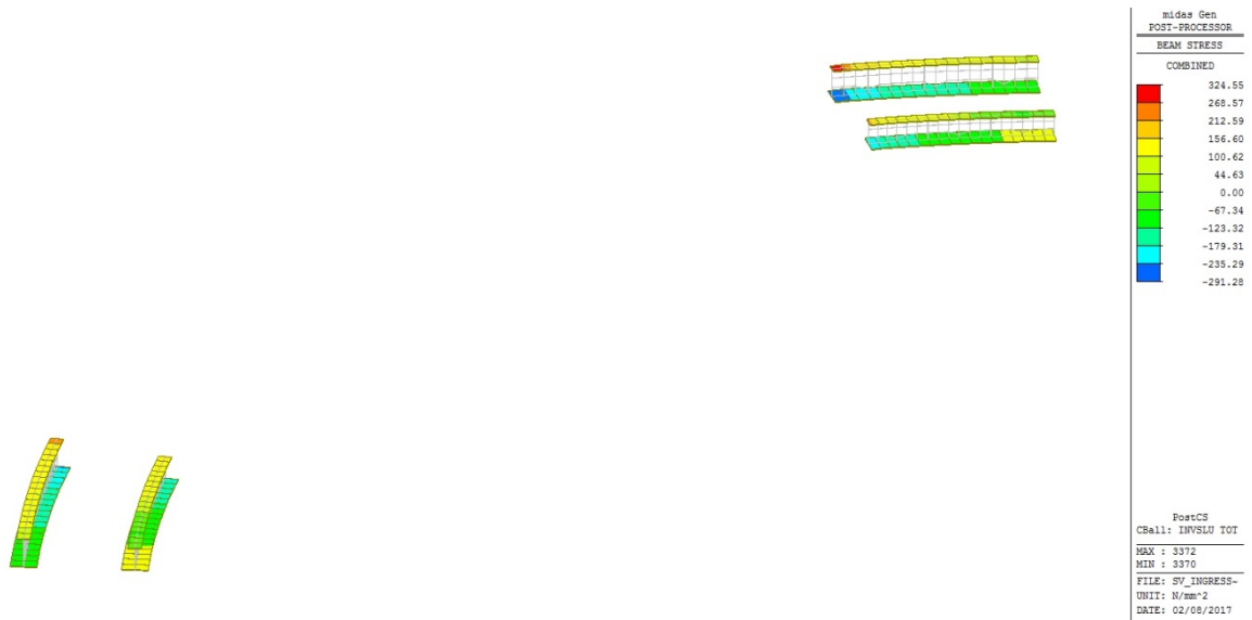
Figura 38 – Involuppo SLU tensioni ideali oid sulle piattabande dei conci 8 / 14 (sp. piatti t \leq 40 mm)
