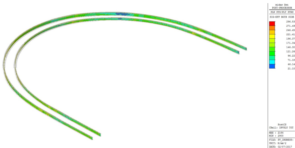
Figura 18 – Inviluppo SLU tensioni ideali \sigma_{id} sulle anime
