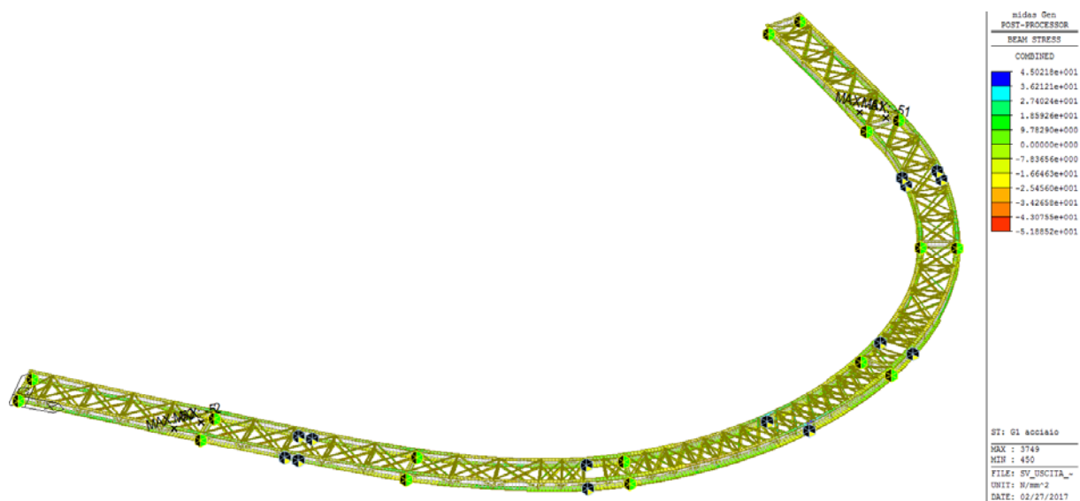
Figura 69 – Tensioni sulle aste in fase di montaggio
