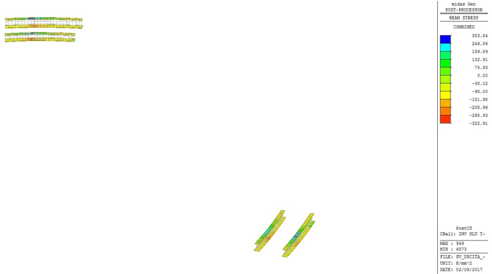
Figura 36 – Involuppo SLU tensioni ideali \sigma_{id} sulle piattabande dei conci 6 / 16 (sp. piatti t \leq 40 mm)
