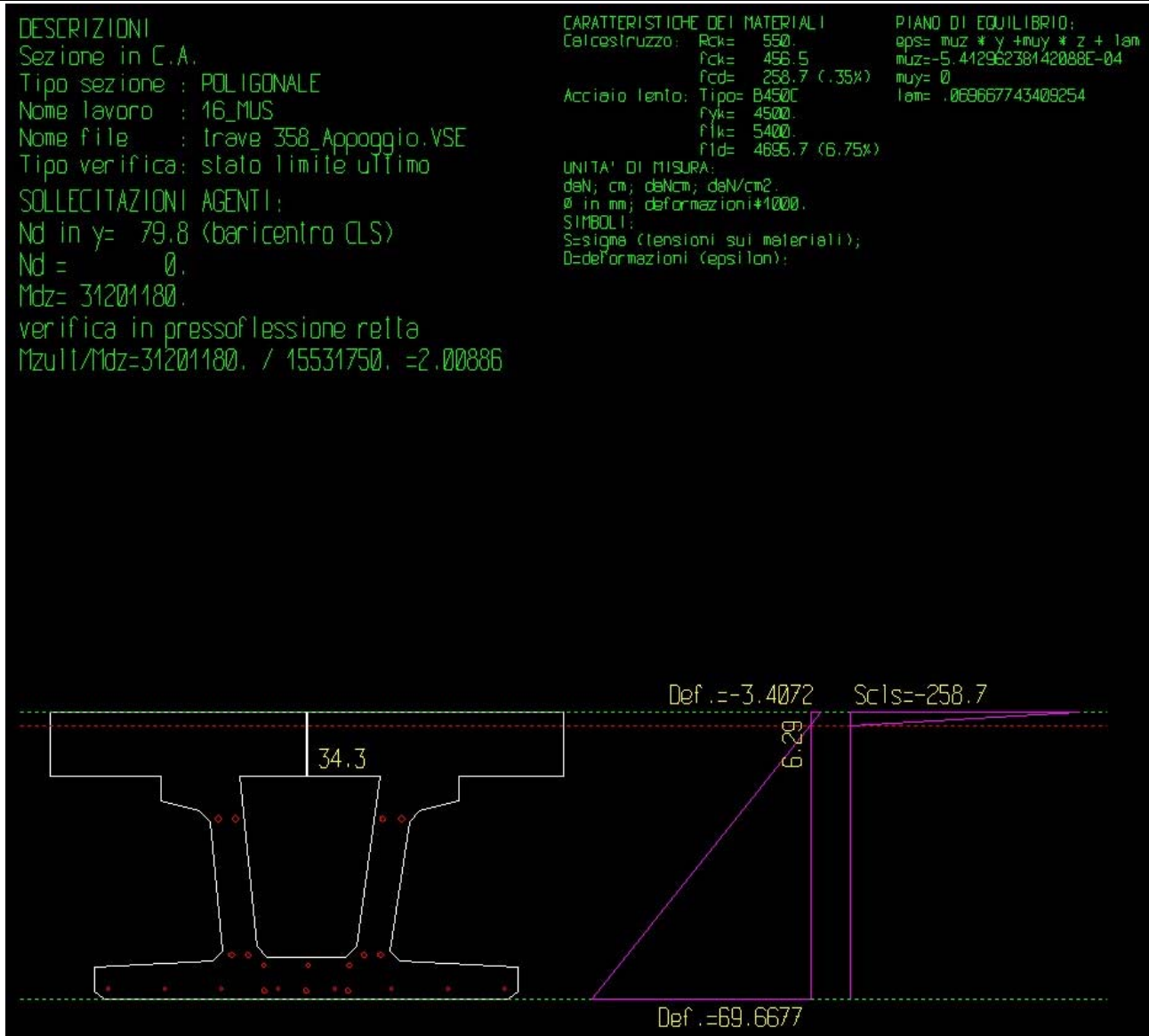
Figura 20 – Verifica SLU sezione appoggio c.a.p.
