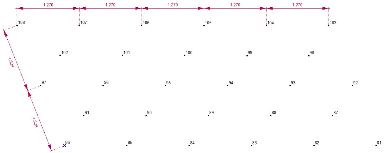
*Figura 21 – Geometria posizionamento micropali*
