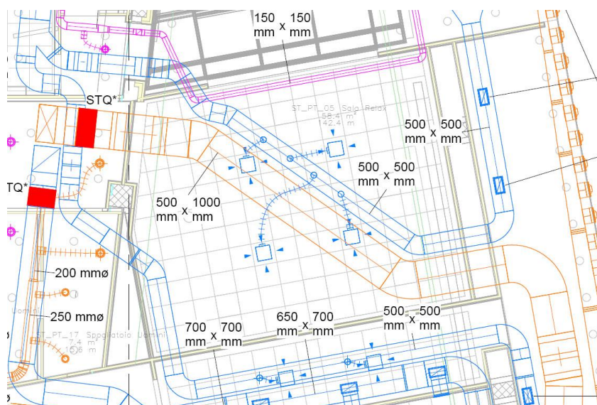
Figura 19: ST_PT_05 SALA RELAX bocchette di mandata e ripresa dell'aria e passaggi del canale di estrazione
