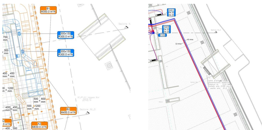
Figura 21: ST_PT_01 INGRESSO/BAR bocchette di mandata dell'aria e lama d'aria all'ingresso
