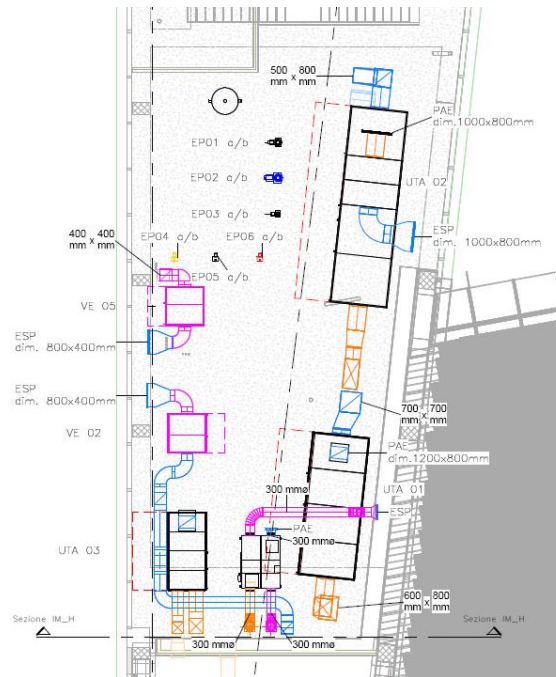
Figura 23: Fabbricato ATC piano primo: planimetria e unità di ventilazione su copertura
