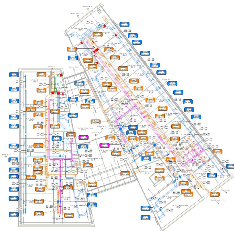
Figura 34: Progetto impianto di climatizzazione; pianta piano terreno, canalizzazioni di mandata e di ripresa
