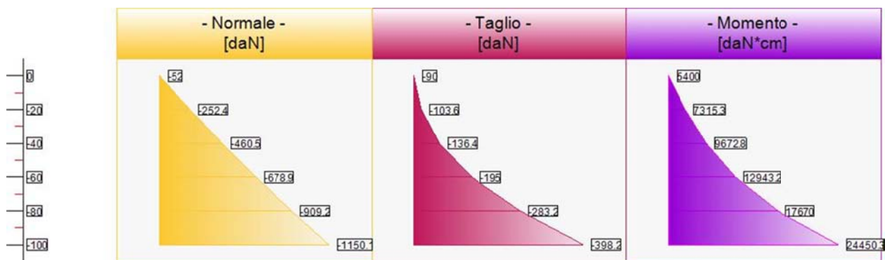
Sollecitazioni lungo il fusto, per il Caso 1 ( STR [ SLU ] - SLU_Str (appr.1;comb.1) )
