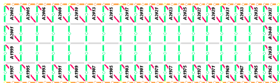
Figura 26: numerazione tiranti inferiori
