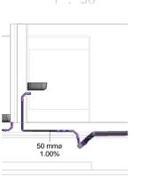
Dettaglio Scarico Vaso a terra
