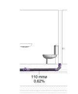
Dettaglio Scarico Vaso Sospeso
