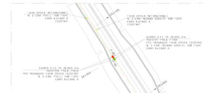
PK 26,055 KM – DETTAGLIO GIUNTO PER FIBRA OTTICA ESISTENTE CAVO INDIANO STARLITE 108 FIBRE – CAVO PIRELLI 108 FIBRE
