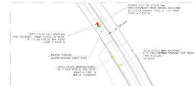
PK 22,900 KM – DETTAGLIO GIUNTO PER FIBRA OTTICA ESISTENTE CAVO INDIANO STARLITE 108 FIBRE – CAVO PIRELLI 108 FIBRE
