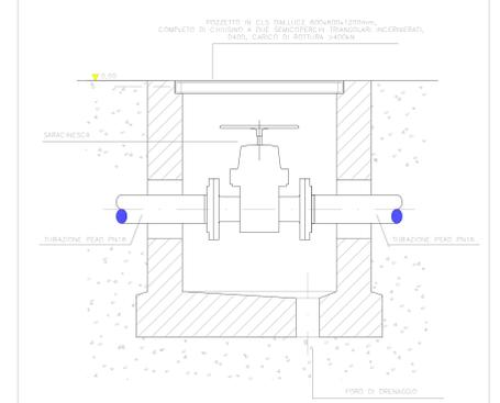
Dettaglio Attacco Autopompa WF
