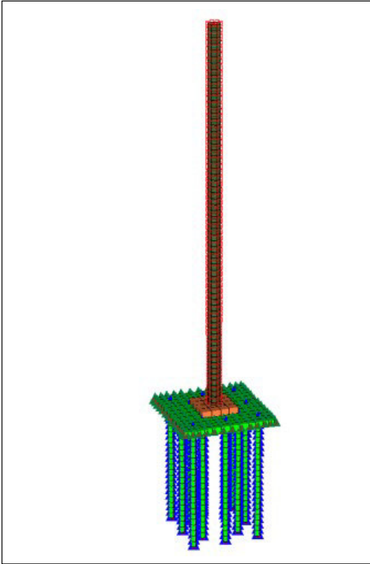
Figura 2_Schema strutturale aerogeneratore
