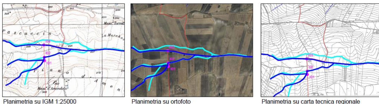
Figura 6 – Confronto del percorso del reticolo idrografico rinvenuto da carta IGM 1:25000 e carta idrogeomorfologica con sovrapposizione su ortofoto e carta tecnica Regionale che meglio rappresentano lo stato dei luoghi
