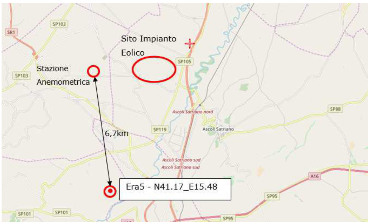
Figura 20: Posizione del sito oggetto di studio rispetto al nodo con i dati di rianalisi ERA5 scelti come stazione di misura di lungo termine
