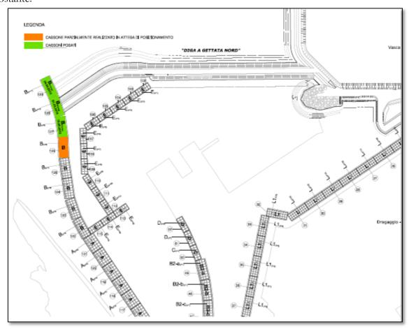
Sono stati posizionati tre cassoni di tipo B (il 01/03, 24/04 e 10/05) per poter consentire la chiusura della testata della diga Nord. E' stato parzialmente prefabbricato un ulteriore cassone di tipo B, la cui produzione è stata sospesa al fine di favorire la costruzione di altri manufatti che hanno richiesto priorità.
