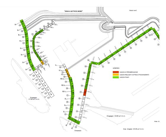
Nel periodo di tempo in esame sono stati collocati in opera 2 cassoni tipo B1. Oltre ai precedenti, alla data odierna sono stati posizionati 11 cassoni di tipo "B", di cui 8 sul braccio di sopraflutto della darsena e 3 sullo sporgente interno dove sono stati di seguito posti in opera i cassoni tipo "B2a", "B2b", "B2c".
