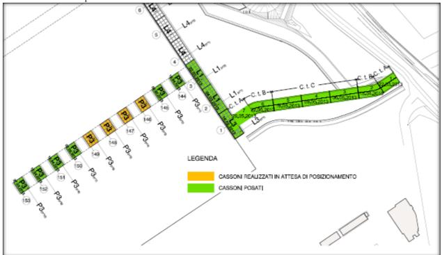
Risulta pertanto completata la fase di posa in opera dei conci scatolari necessari al tombamento del fosso del Bonaugurio. E' in corso di completamento la realizzazione della chiusura dei conci scatolari (posa travi, posa armature di completamento, esecuzione getto della sovrastruttura) che è già stata
