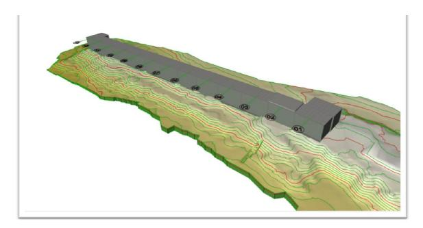
Per quanto concerne lo scanno di imbasamento, è in corso il completamento della sezione definitiva: al 18/07/2014è stato posto in opera il 91,69% dei massi di prima categoria costituenti il nucleo ed il 62,41% della terza categoria costituente la mantellata di protezione esterna (v. restituzione 3D figura sopra riportata).
