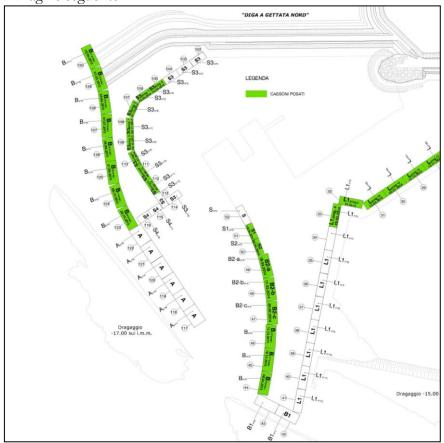
Alla data del presente SAL sono stati posizionati 11 cassoni di tipo "B", di cui 8 sul braccio di sopraflutto della darsena e 3 sullo sporgente interno dove sono stati di seguito posti in opera i cassoni tipo "B2a", "B2b", "B2c", "S1"ed"S2".
