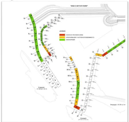
Alla data del 07.03.2014 sono stati posizionati 10 cassoni di tipo "B", di cui 8 sul braccio di sopraflutto della darsena e 2 sullo sporgente interno dove è stato posizionato anche il cassone tipo "B2c" prog.1. Sui cassoni B prog.2 e B prog. 3 sono stati ultimati i muri paraonde di tipo "Rewec" ed i relativi massicci di coronamento.
