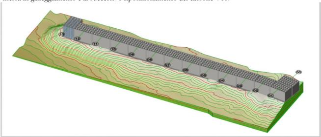
Per quanto concerne lo scanno di imbasamento, è in corso il completamento della sezione definitiva, è stato posto in opera l' 85,97% dei massi di prima categoria costituenti il nucleo ed il 41,77% della terza categoria costituente la mantellata di protezione esterna (v. restituzione 3D figura sopra riportata).
