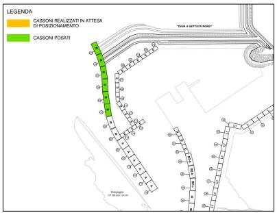
Sono stati posizionati 6 cassoni di tipo B (il 01/03, 24/04 e 10/05, 07/07, 06/08, 21/09) ed è in corso la realizzazione delle sovrastrutture, comprensive di elevazione del muro, su uno dei cassoni di tipo Rewec.
