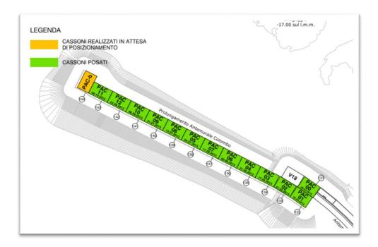
Contestualmente proseguono le lavorazioni accessorie e propedeutiche alla realizzazione delle sovrastrutture: riempimento cassoni, posa dalle, getti di completamento. Nella planimetria sottostante è evidenziato lo stato di avanzamento dello scanno di imbasamento, sovrapposto a quello di progetto. E' in corso il completamento della sezione definitiva. Rimangono da realizzare tutte le sovrastrutture ed il salpamento e ricollocamento del cassone V18.
