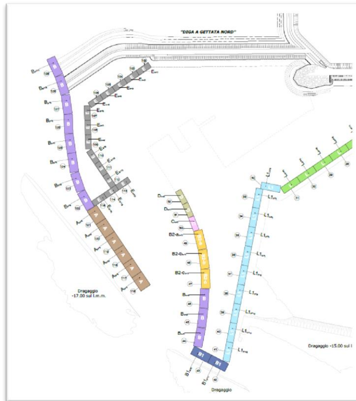
Figura 24: Stralcio planimetria classificazione cassoni Perizia di Variante N°1 – Opere I stralcio funzionale
