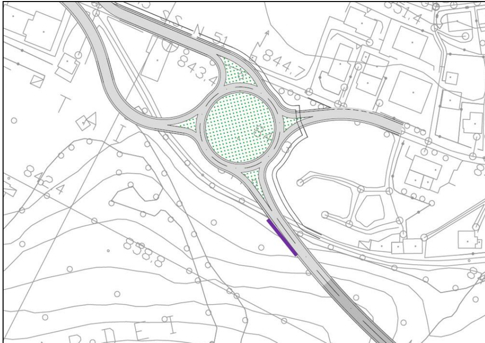
Figura 10 - Muro di controripa zona svincolo Ovest
