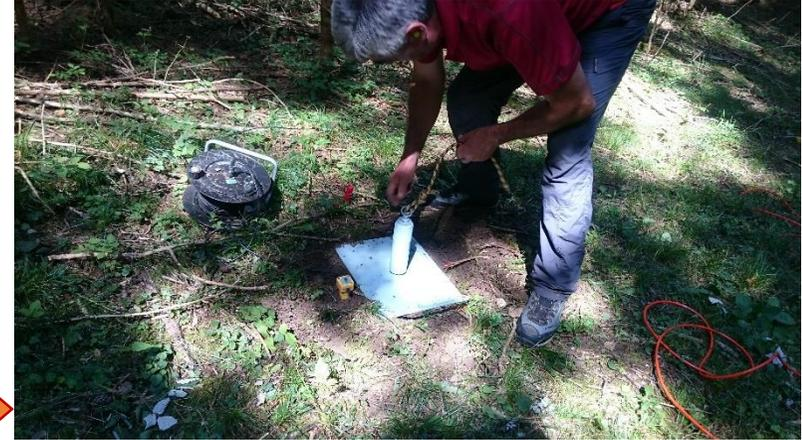
Fig.22: Energizzazione mediante cannone sismico ▶
