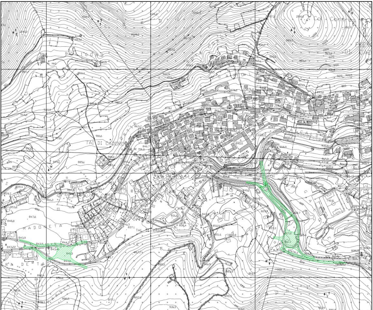
Figura 1. Posizionamento del percorso dell'infrastruttura nella Carta Tecnica Regionale con i tratti di scavo "fuori terra" evidenziati.
