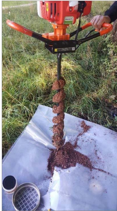
Figura 43 – Aliquota di terreno prelevata con la trivella
