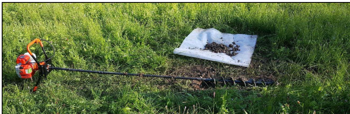
Figura 42 – Trivella motorizzata dotata di prolunghe
