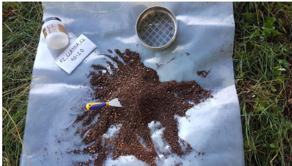
Figura 44 – Esempio setacciatura e omogeneizzazione del campione
