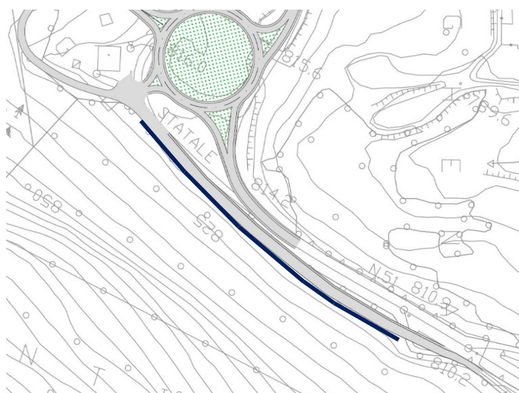
Figura 14 Muro di controripa zona svincolo Est (direzione Maias)
