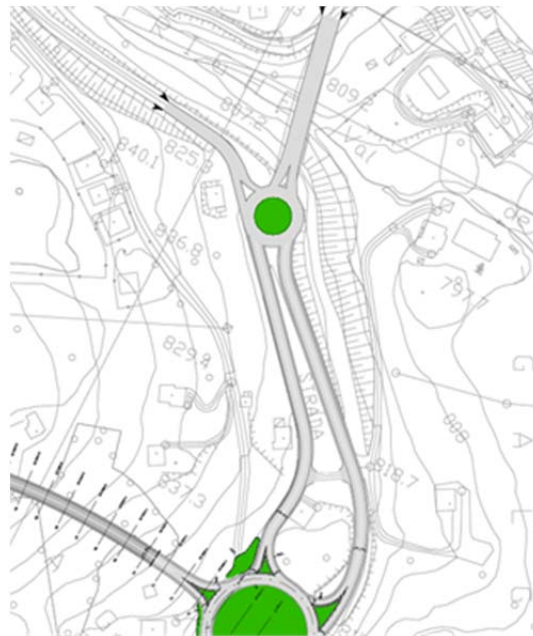
Figura 4 Piccola rotatoria a nord dello svincolo Est
