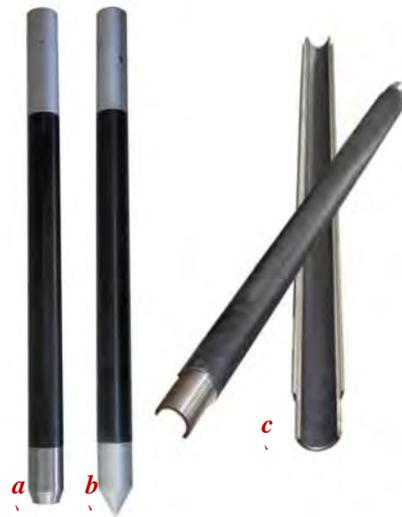
Fig. 2: Campionatore Raymond. a) a punta aperta; b) a punta chiusa; c) tubo diviso longitudinalmente senza punte.
