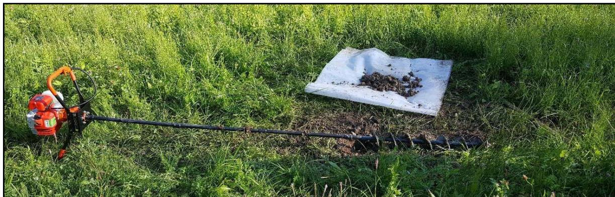
Figura 40 – Trivella motorizzata dotata di prolunghe
