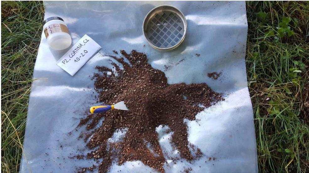
Figura 42 – Esempio setacciatura e omogeneizzazione del campione
