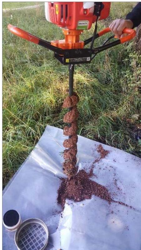
**Figura 41** – *Aliquota di terreno prelevata con la trivella*
