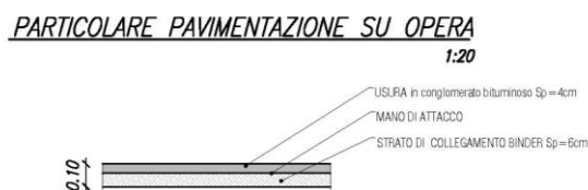
Figura 7: Pacchetto di pavimentazione Asse TR2
