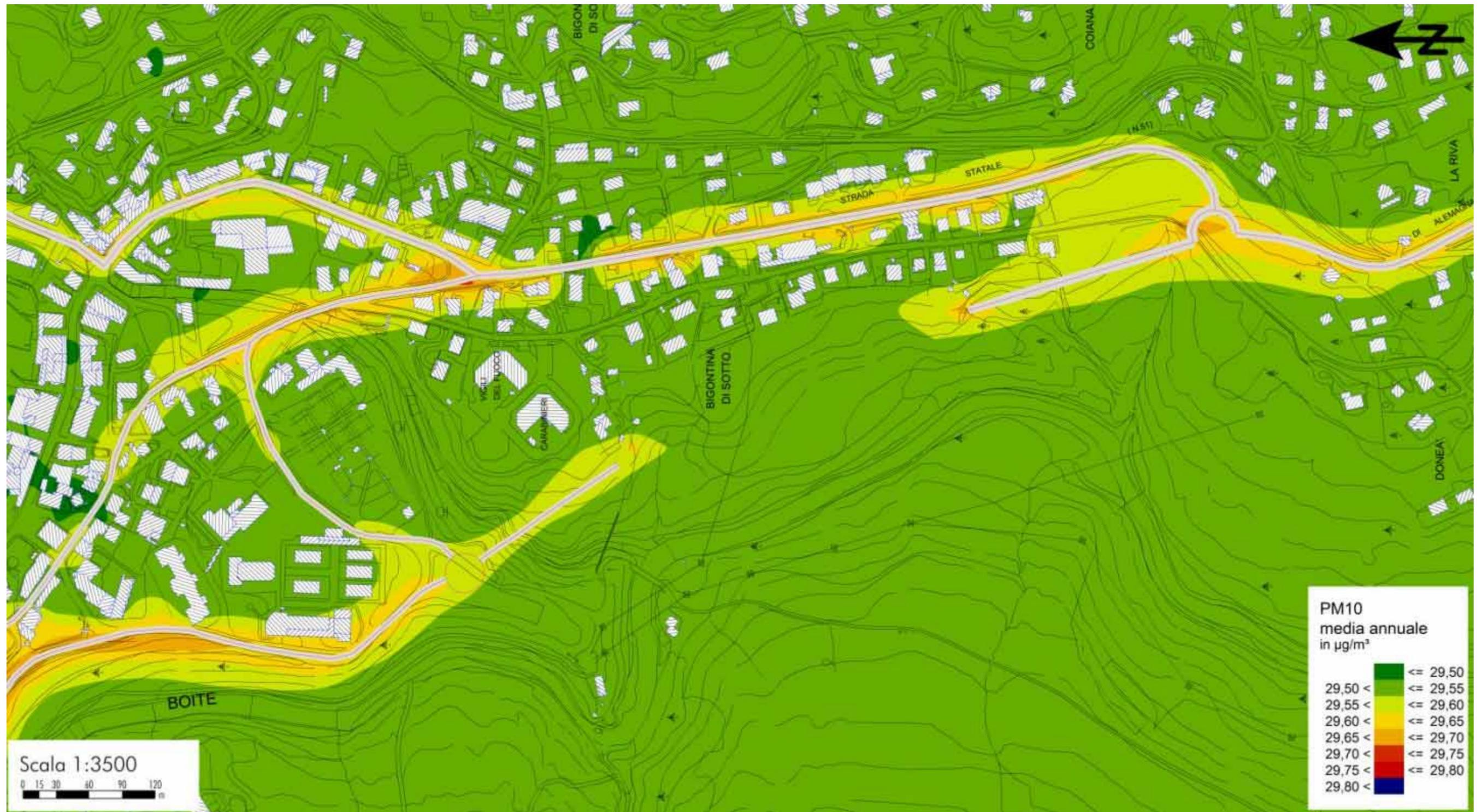
Figura 97: Concentrazione media annuo di PM10 dovuta al traffico sulla S.S. 51 - Alemagna e sulla viabilità principale allo stato di progetto considerando un valore di background di  $29,5 \mu\text{g}/\text{m}^3$ .
