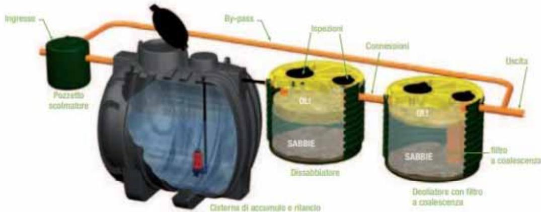
Figura 32: Schema tipo di impianto di trattamento acque di prima pioggia
