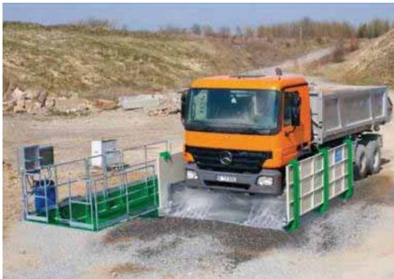
*Figura 28: Impianti di lavaggio gomme automezzi*
