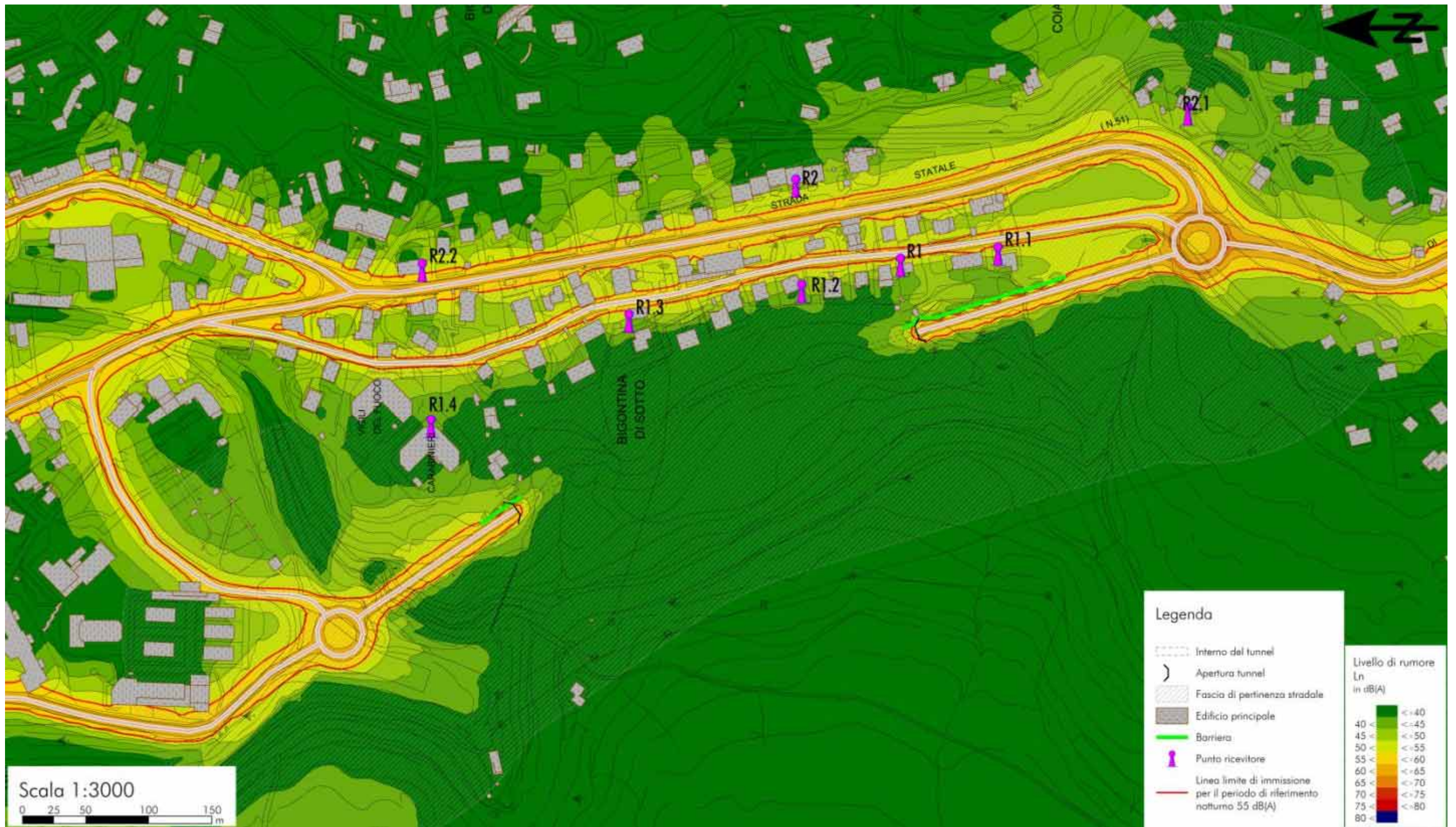
Figura 35: Situazione a 4 m dal suolo della diffusione acustica dei livelli di immissione allo stato di progetto nel periodo di riferimento notturno.
