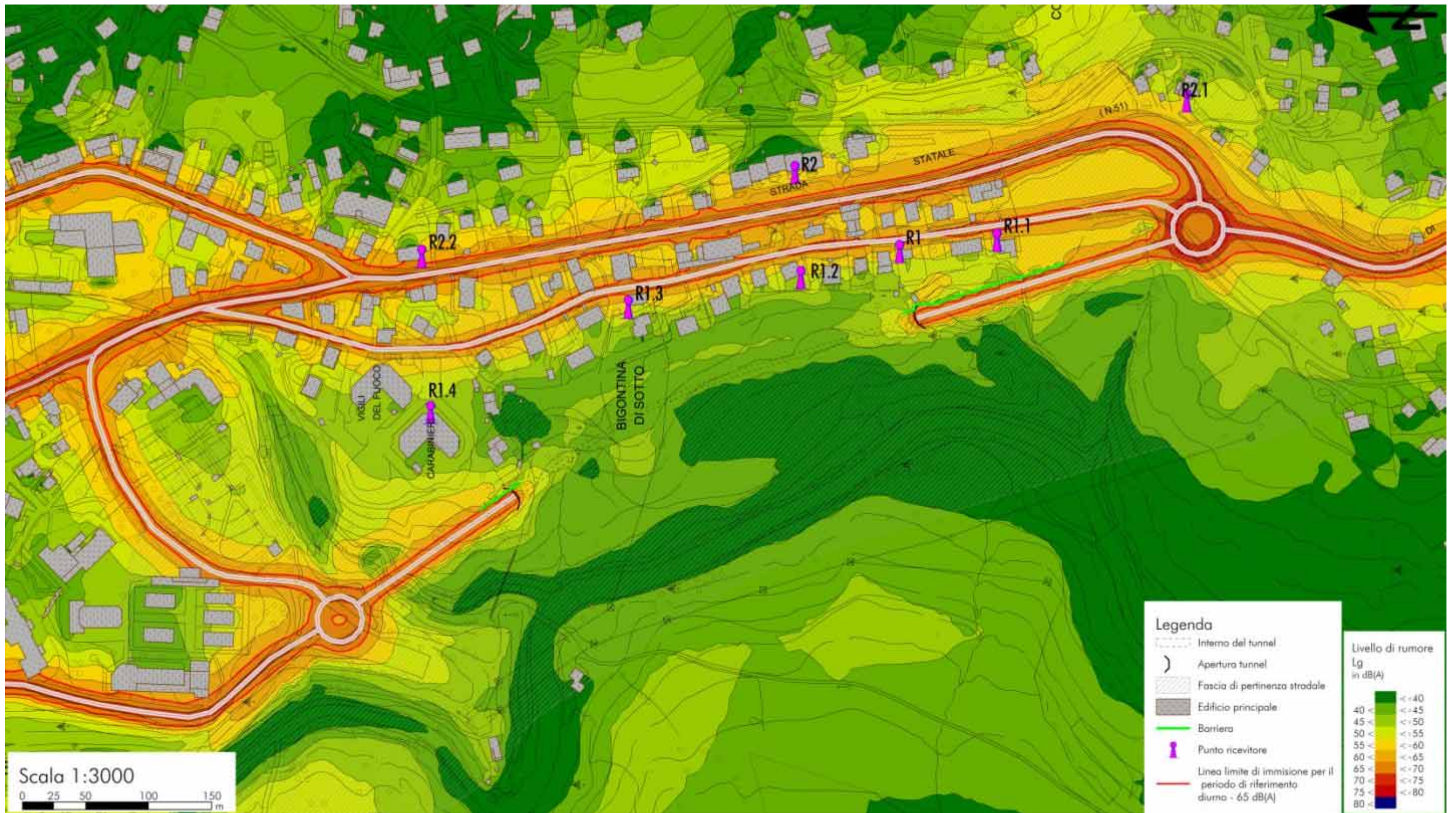
Figura 33: Situazione a 4 m dal suolo della diffusione acustica dei livelli di immissione allo stato di progetto nel periodo di riferimento diurno.
