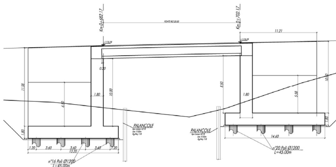
Figura 41: Sezione Longitudinale del Ponte Ries (ns. elaborazione da tavola T01VI03STRDI01\_A\_Pianta impalcato, sezione longitudinale e dettagli del progetto definitivo).
