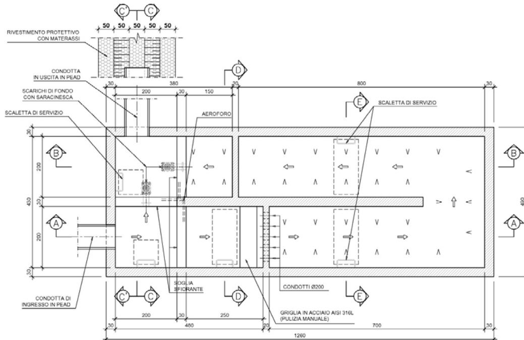
Figura 47: Pianta vasca prima pioggia (ns. elaborazione da tavola T00ID00IDRDI01\_A\_Vasca trattamento acque di piattaforma - Carpenteria del progetto definitivo).
