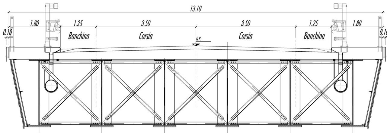
Figura 45: Prospetto del Ponte sul Rio Bigontina (ns. elaborazione da tavola T01VI02STRDI01\_A\_Sezione longitudinale, prospetto e schema appoggi del progetto definitivo).
