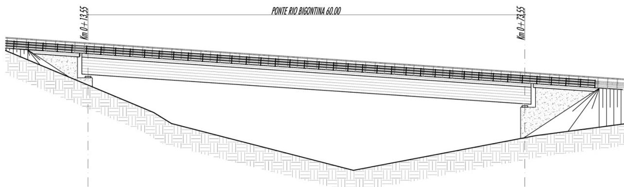
Figura 44: Prospetto del Ponte sul Rio Bigontina (ns. elaborazione da tavola T01VI02STRDI01\_A\_Sezione longitudinale, prospetto e schema appoggi del progetto definitivo).
