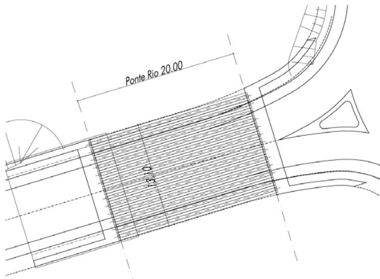
Figura 40: Pianta del Ponte Ries (ns. elaborazione da tavola T01VI03STRDI01\_A\_Pianta impalcato, sezione longitudinale e dettagli del progetto definitivo).
