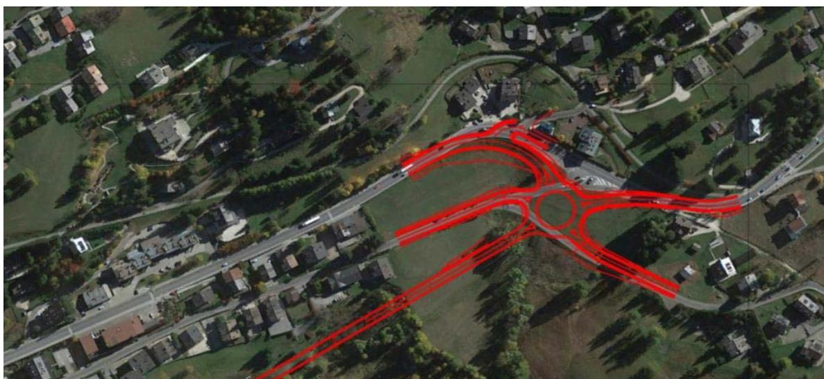
Figura 38: Planimetria della rotonda di stacco dalla S.S. 51 Alemagna
