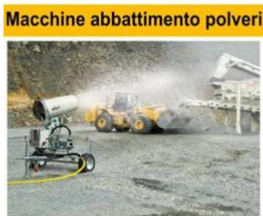
Figura 9: Nebulizzatore per abbattimento polveri
