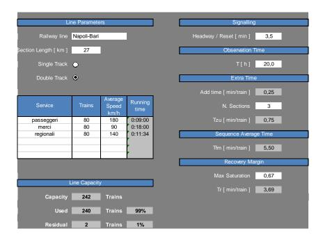
Esempio di saturazione della capacità commerciale della linea con 6 tracce /ora per senso di marcia.
