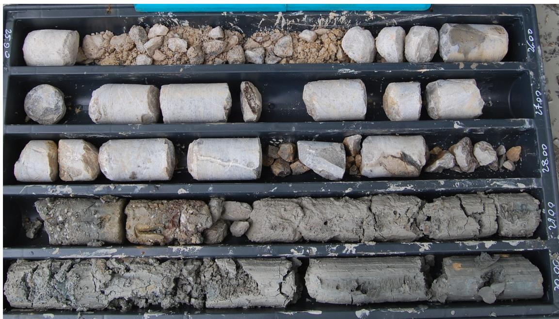
Foto 7 – Argille varicolori tipiche in carotaggio, olistolite calcareo nelle argilliti.
