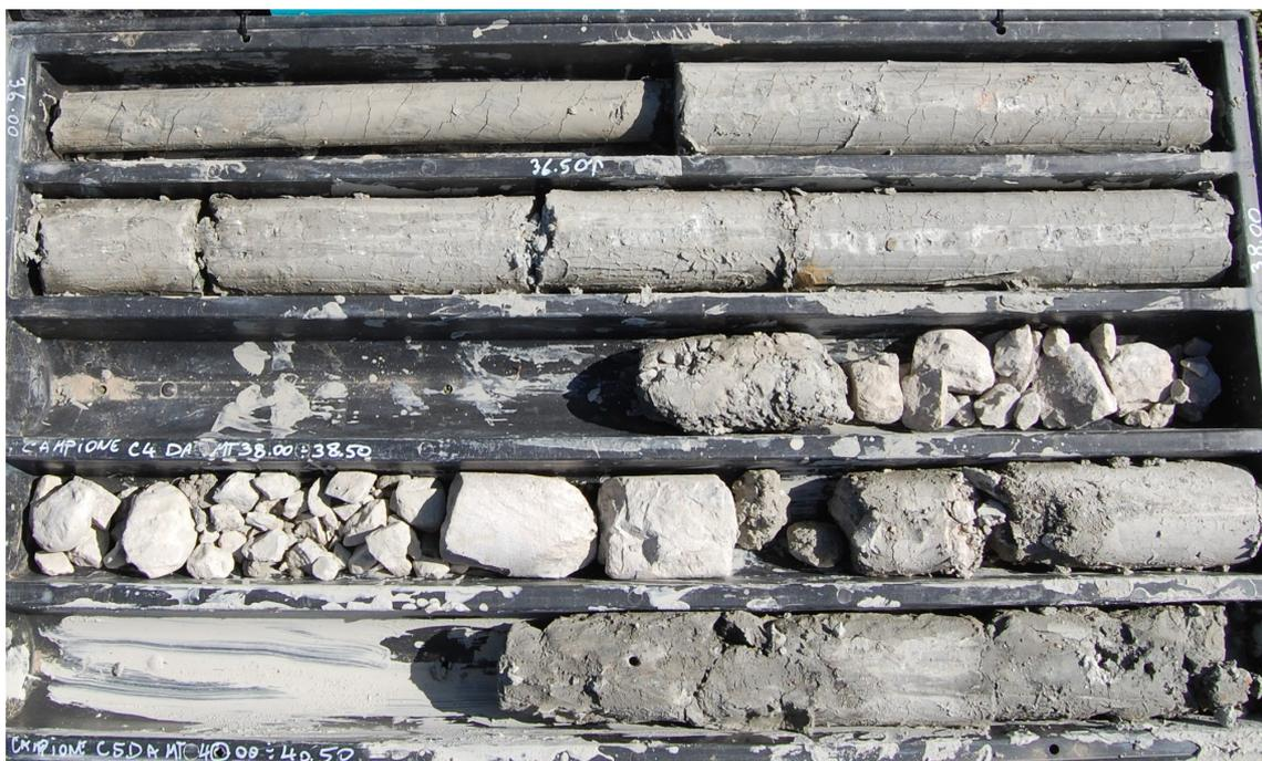
Foto 6 – Argille varicolori tipiche in carotaggio, prevalenza argillitica con intercalazione arenacea.
