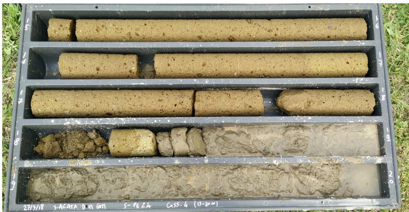
Foto 9 – Carote di “tufo giallo” tipico attraversato con i sondaggi (PE-S24, Viadotto San Michele). Passaggio alla sottostante litofacies “sciolta” del TGC, dilavata dalla perforazione
