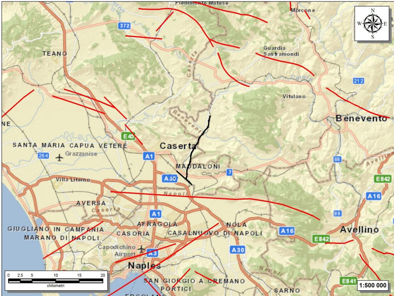
Figura 22 – Stralcio cartografico dell'area di studio con indicazione della tratta ferroviaria di progetto (in nero) e delle faglie capaci (in rosso) (<http://sgi.isprambiente.it/ArcGIS/rest/services/servizi/ithaca/MapServer>).
