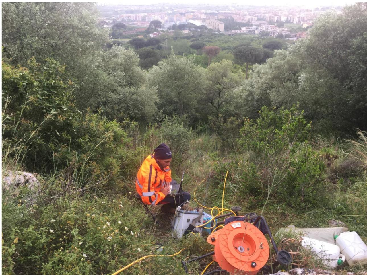
Figura 18 – Fasi di acquisizione ERT passo 10 m.
