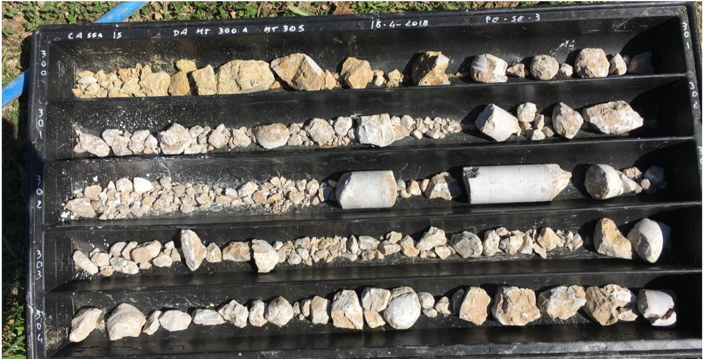
Sondaggio PE-S03 da 300 a 305 m
