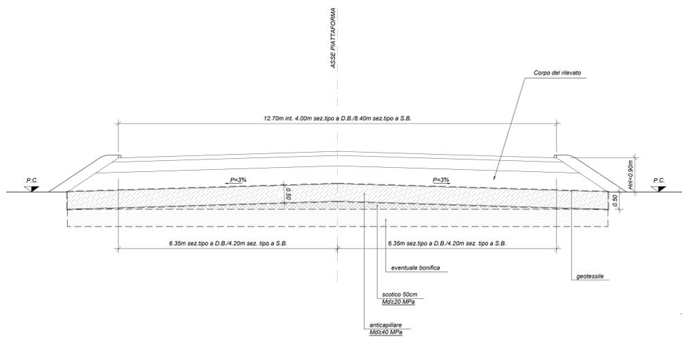
Sezione tipo in rilevato -  $H_{ril} > 1,10$  m
