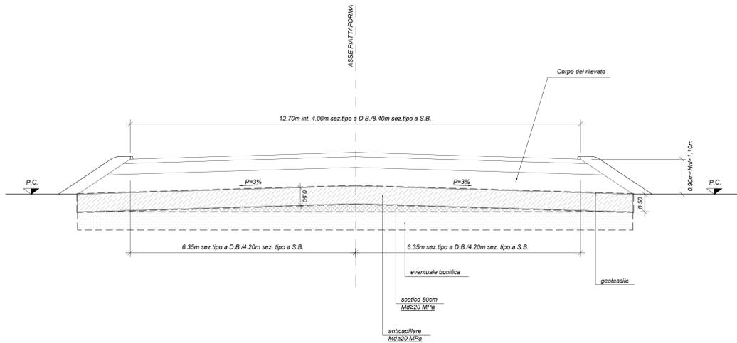
Sezione tipo in rilevato - Piano di posa inclinato con  $p > 15\%$
