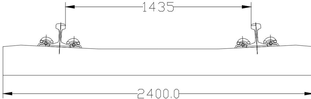
Il binario sarà armato con traverse tipo RFI 240 di lunghezza 2,40 m dotata di attacco di tipo elastico conforme alle Specifiche Tecniche RFI con scartamento di 1435 mm.
