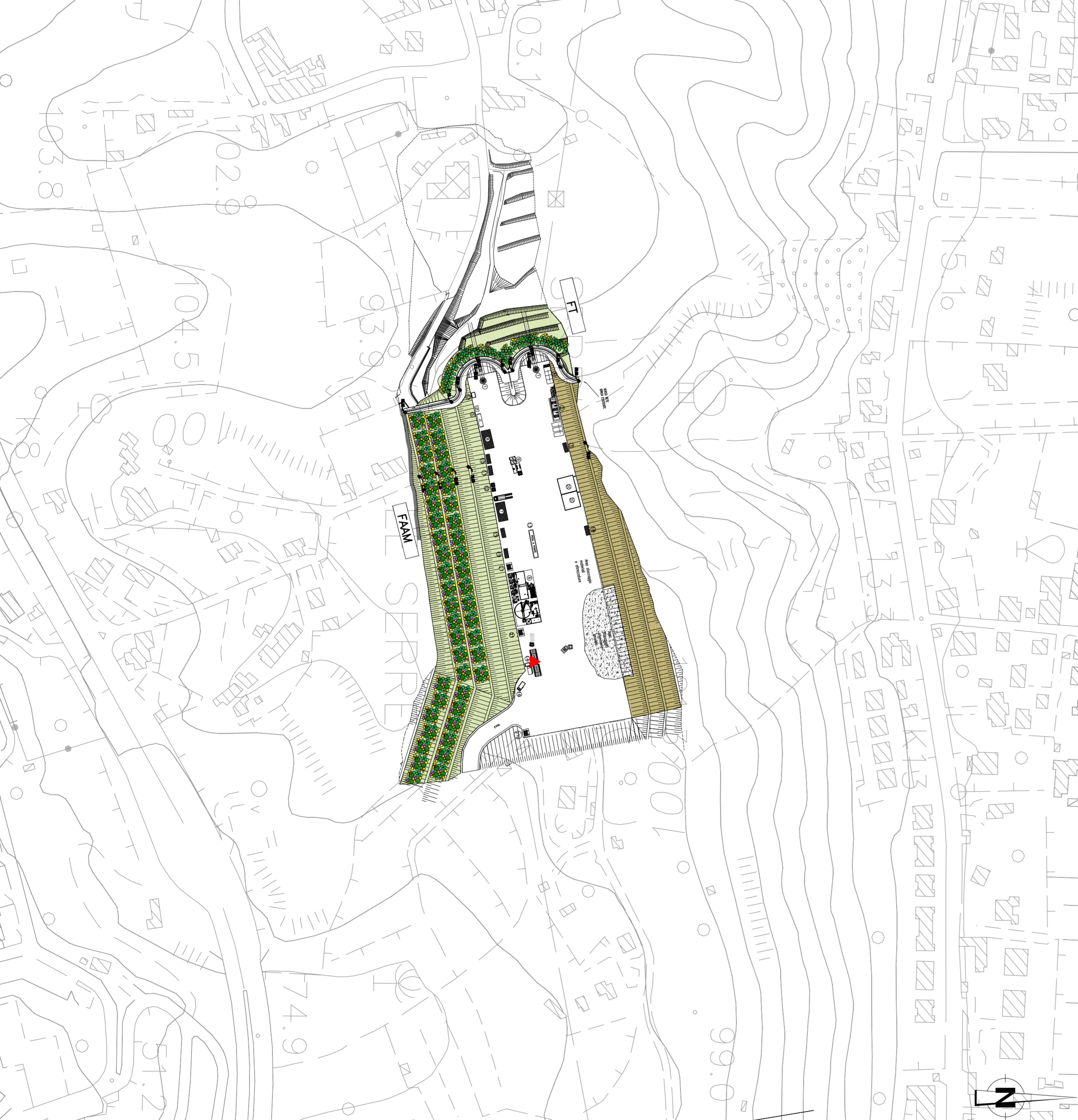
MITIGAZIONI DEL CANTIERE IN FASE DI COSTRUZIONE DELL'OPERA - SCALA 1:2000 CANTIERE S12 - FARO SUPERIORE
