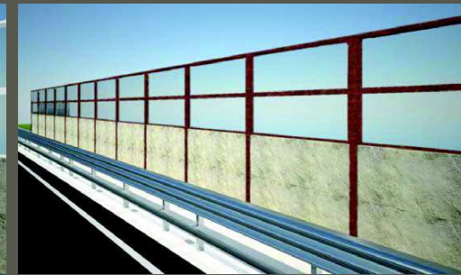
La barriera lato infrastruttura
