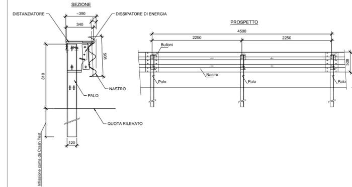
SEZIONE TIPO IN RILEVATO - RAMO Km 2+962
