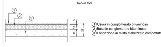
DETTAGLIO PAVIMENTAZIONE STRADALE
