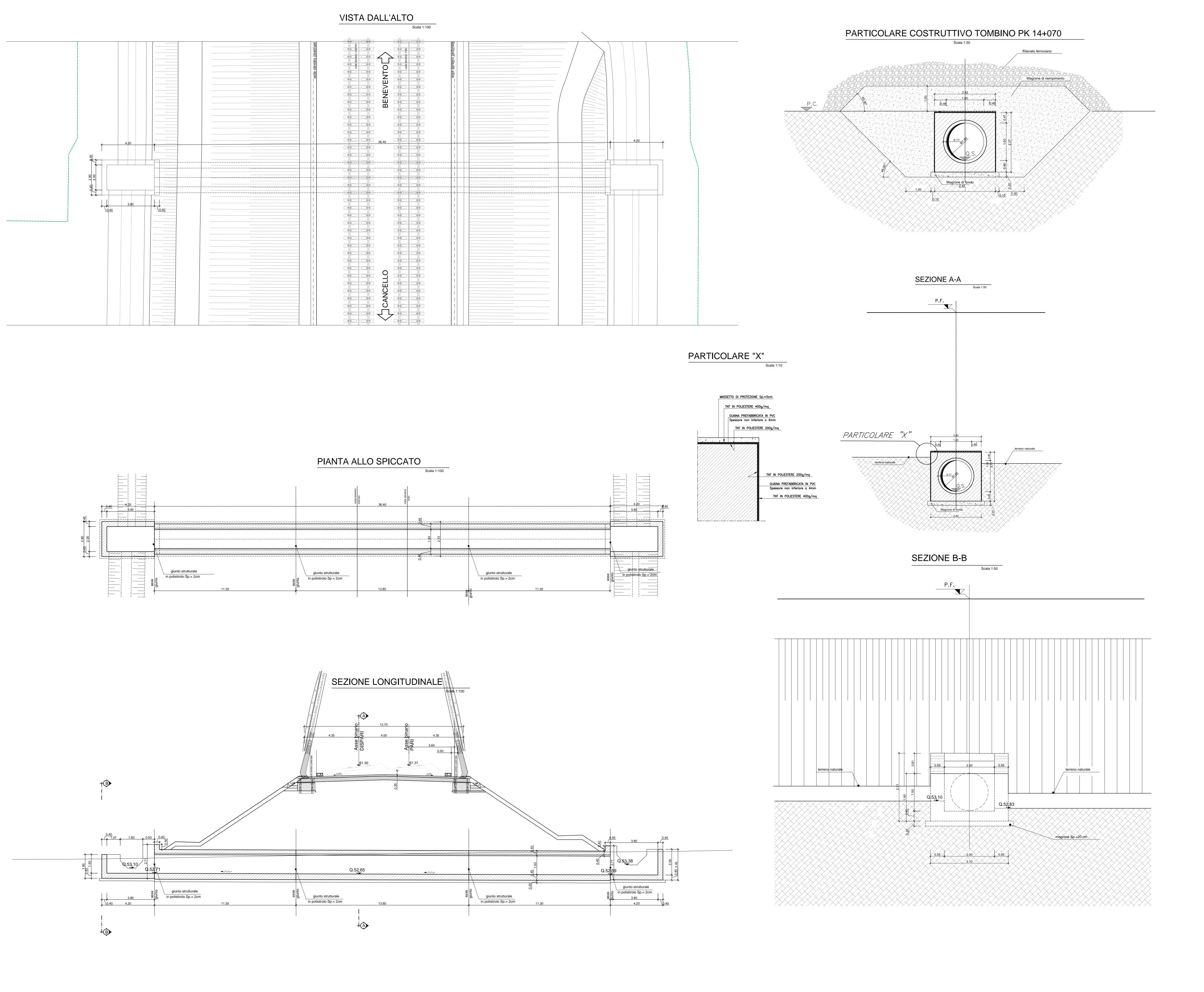
CARATTERISTICHE DEI MATERIALI CALCESTRUZZI: ACCIAI: CALCESTRUZZO MAGRO: BARRE E RETI ELETTROSALDATE - Classe Rck = 15 MPa (C 12/15) B450C controllato in stabilimento Armature: - Classe di esposizione ambientale X0 (UNI EN 206-1) STRUTTURALE (Solettone di fondo e fodera interna):
