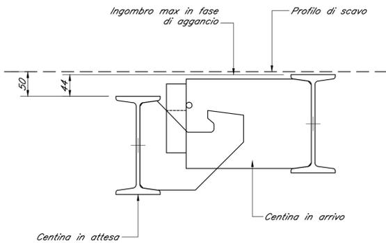
SCHEMA LONGITUDINALE INTERASSE 1.00m scala 1:50
